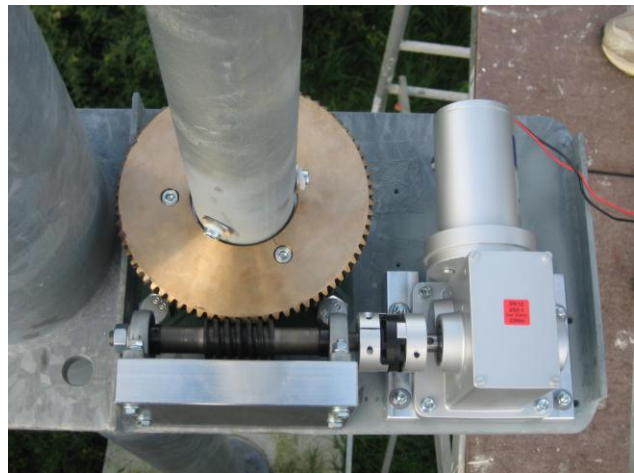
Bild 12, oben: Die Antriebseinheit für den Azimut (horizontale Drehung)
